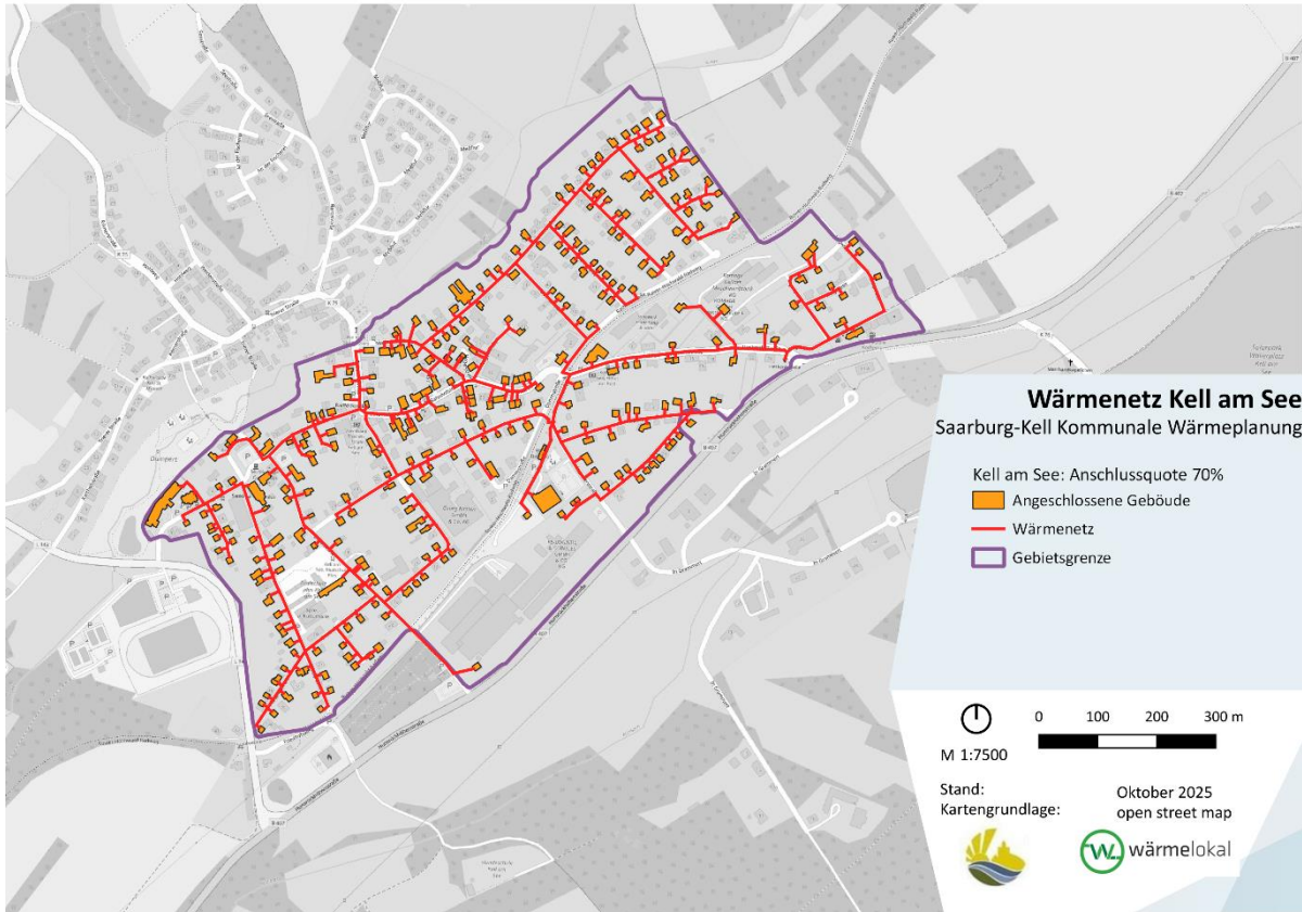
Abbildung 107 | Wärmenetz Kell am See (Anschlussquote 70%)
